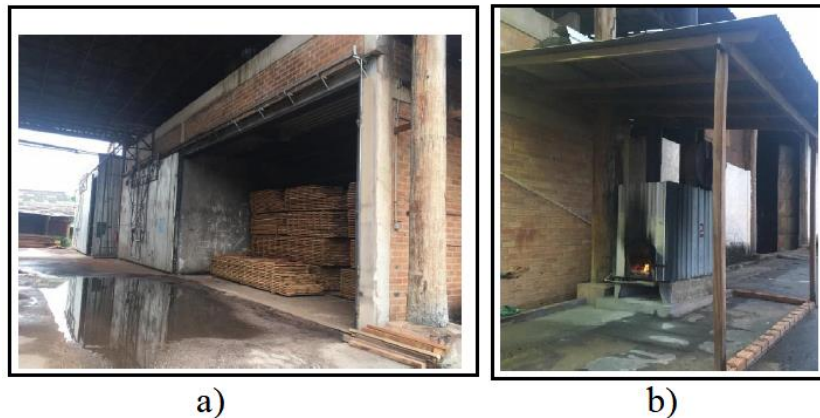
Figura 1 a) Uma das quatro estufas de secagem da empresa. b) Fornalha à lenha das estufas.
