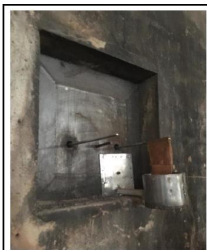
Figura 3 – Medição de umidade através de sensor de bulbo seco/bulbo úmido no interior de uma das estufas de secagem.
