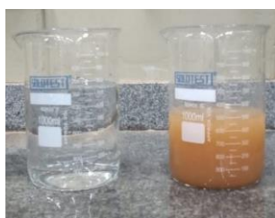
Figura 6: 1ª lavagem agregado reciclado. Figura 7: Última lavagem agregado reciclado.
