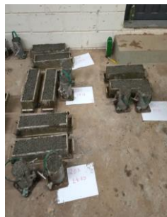
Figura 18: Moldagem dos Corpos de prova.
