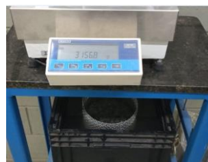
Figura 15: Agregado granítico submerso.
