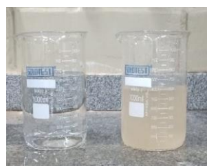
Figura 6: 1ª lavagem agregado reciclado. Figura 7: Última lavagem agregado reciclado.
