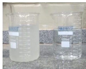
Figura 8: 1ª lavagem agregado granítico. Figura 9: Última lavagem agregado granítico.
