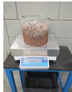
Figura 13: Pesagem do agregado reciclado.
