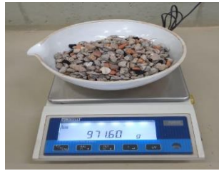
Figura 10 – Agregado reciclado seco. Figura 11 – Agregado granítico seco.
