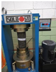
Figura 19: Ensaio de compressão axial.
