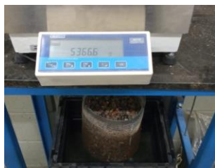
Figura 16: Agregado reciclado saturado. Figura 17: Agregado reciclado submerso.
