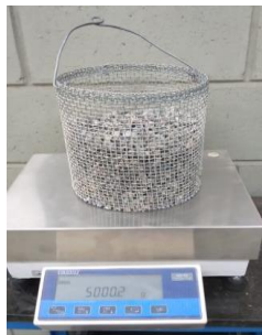
Figura 12: Pesagem do agregado granítico.
