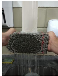
Figura 21: Ensaio de permeabilidade. Figura 22: Ensaio de permeabilidade.
