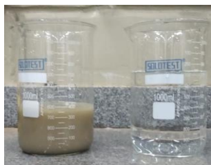
Figura 8: 1ª lavagem agregado granítico. Figura 9: Última lavagem agregado granítico.
