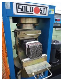
Figura 20: Ensaio de tração na flexão.
