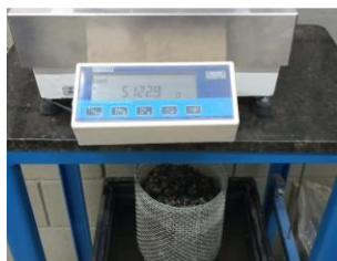
Figura 14: Agregado granítico saturado.
