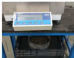
Figura 16: Agregado reciclado saturado. Figura 17: Agregado reciclado submerso.
