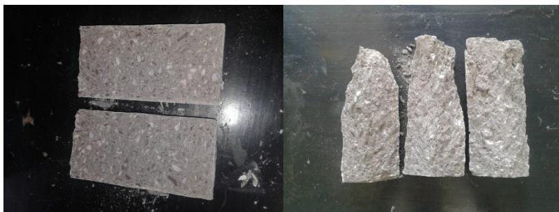
Figura 4 - Ensaio mecânicos : a) Ruptura por compressão diametral; e b) Ruptura por compressão axial
