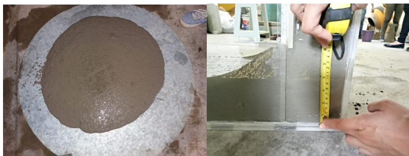
Figura 3 - Ensaio de autocompactabilidade: a) Espalhamento do CAA; e b) Ensaio da Caixa L.
