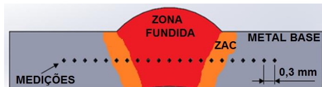
Figura 3 – Esquema de obtenção dos perfis de microdureza
