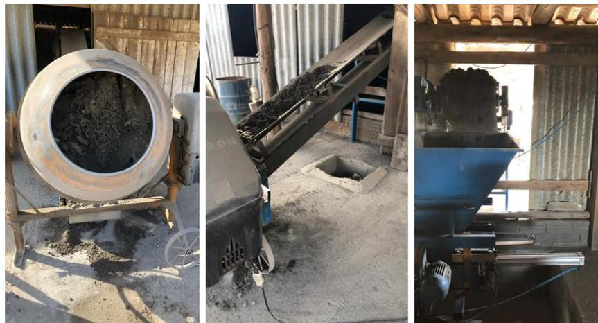
Figura 3 - Homogeneização e abastecimento do silo da Máquina vibro-prensa.
