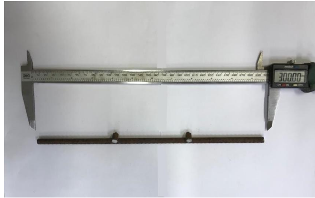
Figura 3 – Vergalhão de aço CA-60 com diâmetro nominal de 7 mm e 30 cm de comprimento retirado de uma tela soldada com espaçamento de 10 cm entre barras
