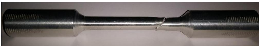
Figura 4 - Corpo de prova de tração após realização do ensaio
