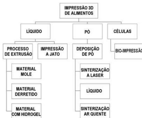
Figura 10 – Divisão de Técnicas em Manufatura Aditiva para Alimentos em 3D. Fonte: Adaptado de Godoi *et al.* (2018).
