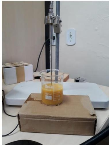
Figura 1: Amostra apoiada para imersão da sonda coaxial utilizada para medição de permissividade elétrica.
