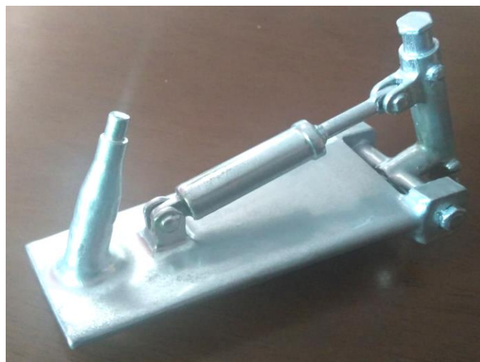
Figura 9 – Protótipo via manufatura aditiva FDM em plástico do tipo PLA.
