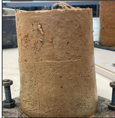
Figura 8 – Amostras para o teste de resistência mecânica.
