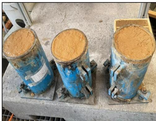
Figura 7 – Moldes cilíndricos.
