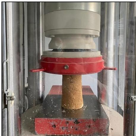
Figura 9 – Corpo de prova cilíndrico colocado verticalmente.
