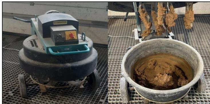
Figura 4 – Preparação da mistura no misturador Proviteq.
