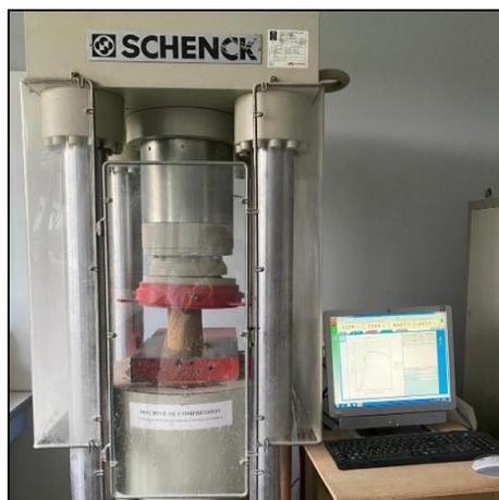
Figura 10 – Equipamento para os testes de compressão SCHENCK.
