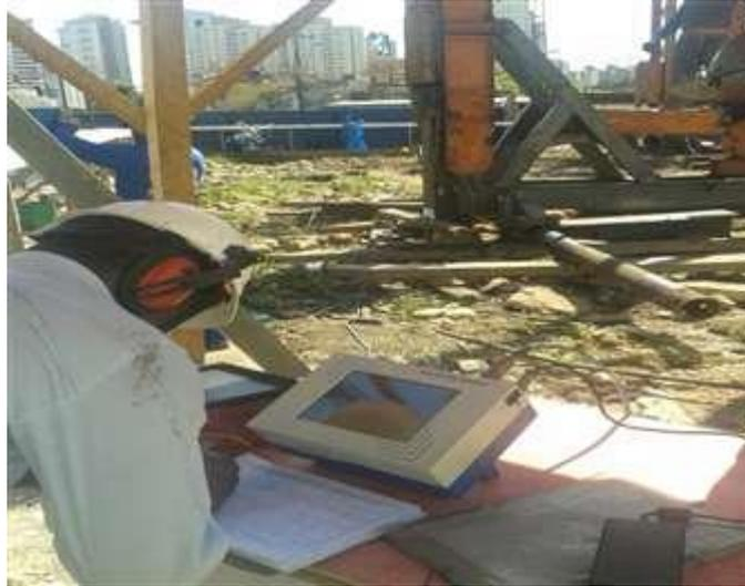
Figura 7 - Equipamento de análise PDA.
