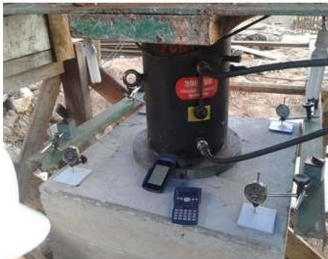
Figura 8 - Sistema de reação com macaco hidráulico.
