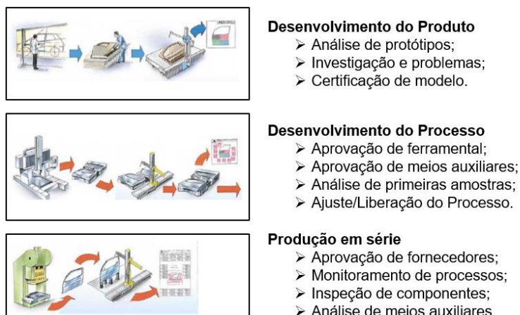
Figura 3 - Sistema de medição por coordenadas nas fases de um produto Fonte: Adaptado de Oliveira (2003)
