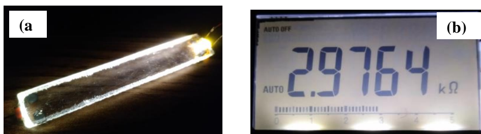
Figura 5. (a) Lâmina de vidro com ausência de gotas. (b) Valor ôhmico registrado pelo LDR. Fonte: autores.
