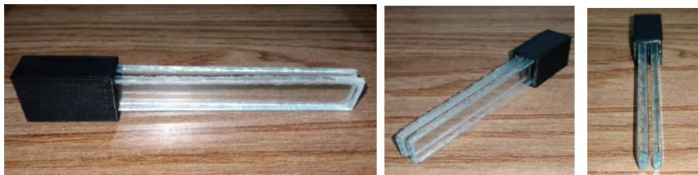
Figura 8. Arranjo experimental com as lâminas paralelas. Fonte: autores
