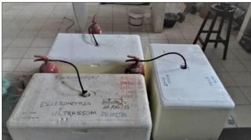
Figura 1 – Câmaras de carbonatação.
