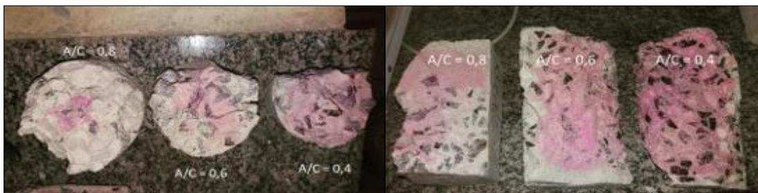
Figura 7 - Seções transversais e longitudinais carbonatadas dos corpos de prova e cubos de concreto, respectivamente.
