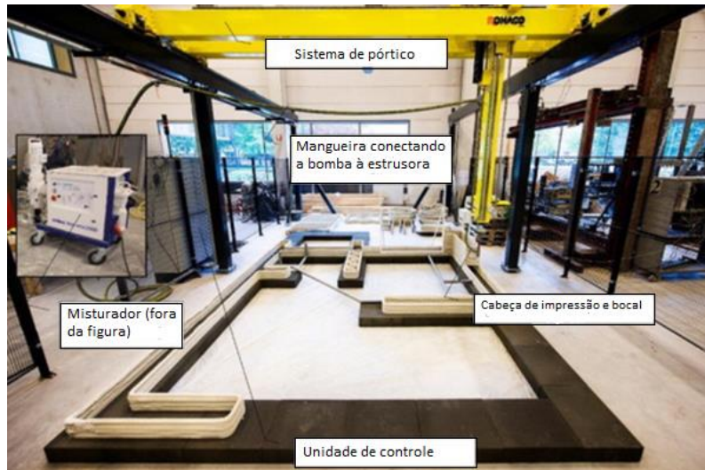
Figura 1 – Impressora 3D de concreto de pórtico Fonte: EL Sayegh et al, (2020) - adaptado
