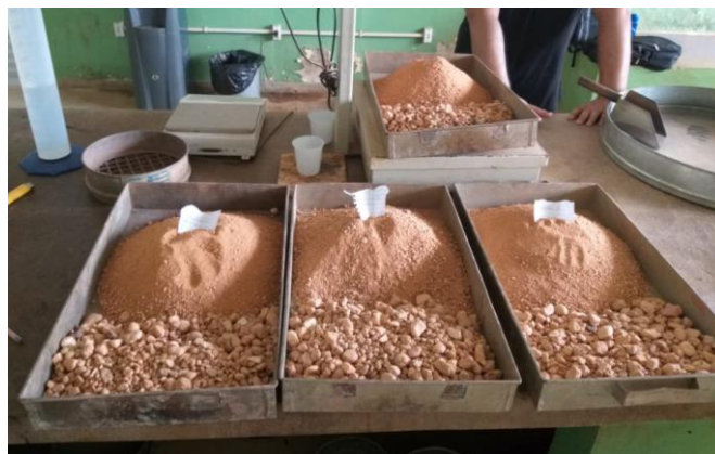
Figura 3 - Separação das faixas granulares do solo
