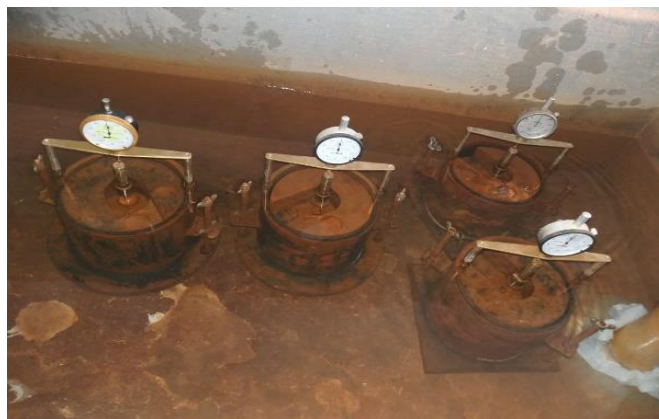
Figura 5 - Corpos de prova submersos
