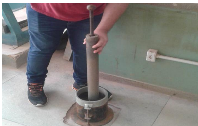
Figura 4 - Execução do ensaio de compactação
