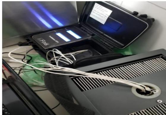
Figura 4. Teste em banho de calibração.
