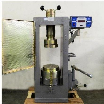
Figura 7 – Prensa Manual para Ensaio de Concreto - Contenco.
