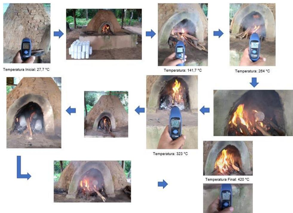
Figura 5 – Etapas da simulação de incêndio no forno cerâmico caseiro.
