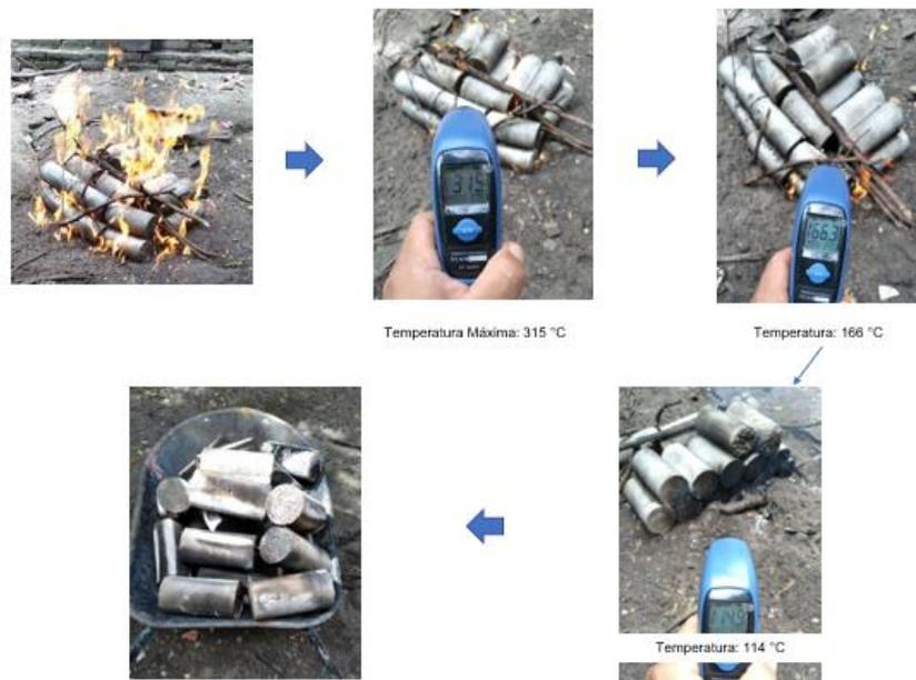
Figura 6 – Etapas da simulação de incêndio através da utilização de gasolina.
