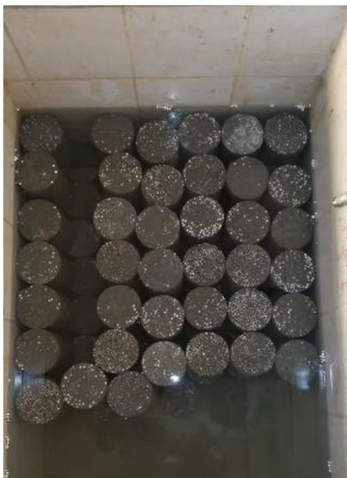
Figura 3 – Corpos de prova acondicionados em tanques de água potável para cura
