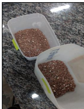
Figura 1 – RCV após moagem e peneiramento
