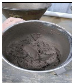
Figura 2 - Fabricação da massa na argamassadeira
