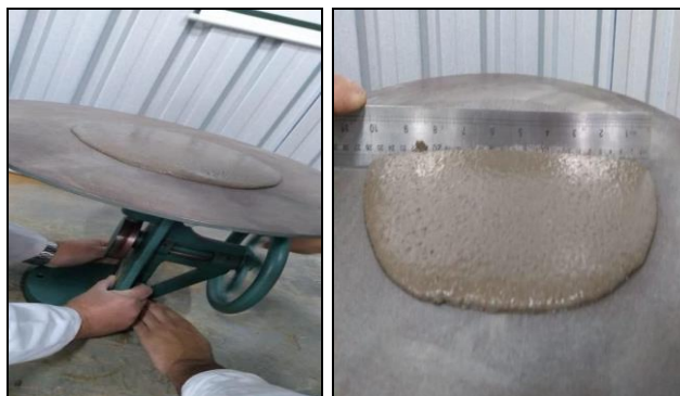
Figura 3 - Ensaio de Índice de Consistência Flow Table a) Medição após ensaio de Flow Table b)
