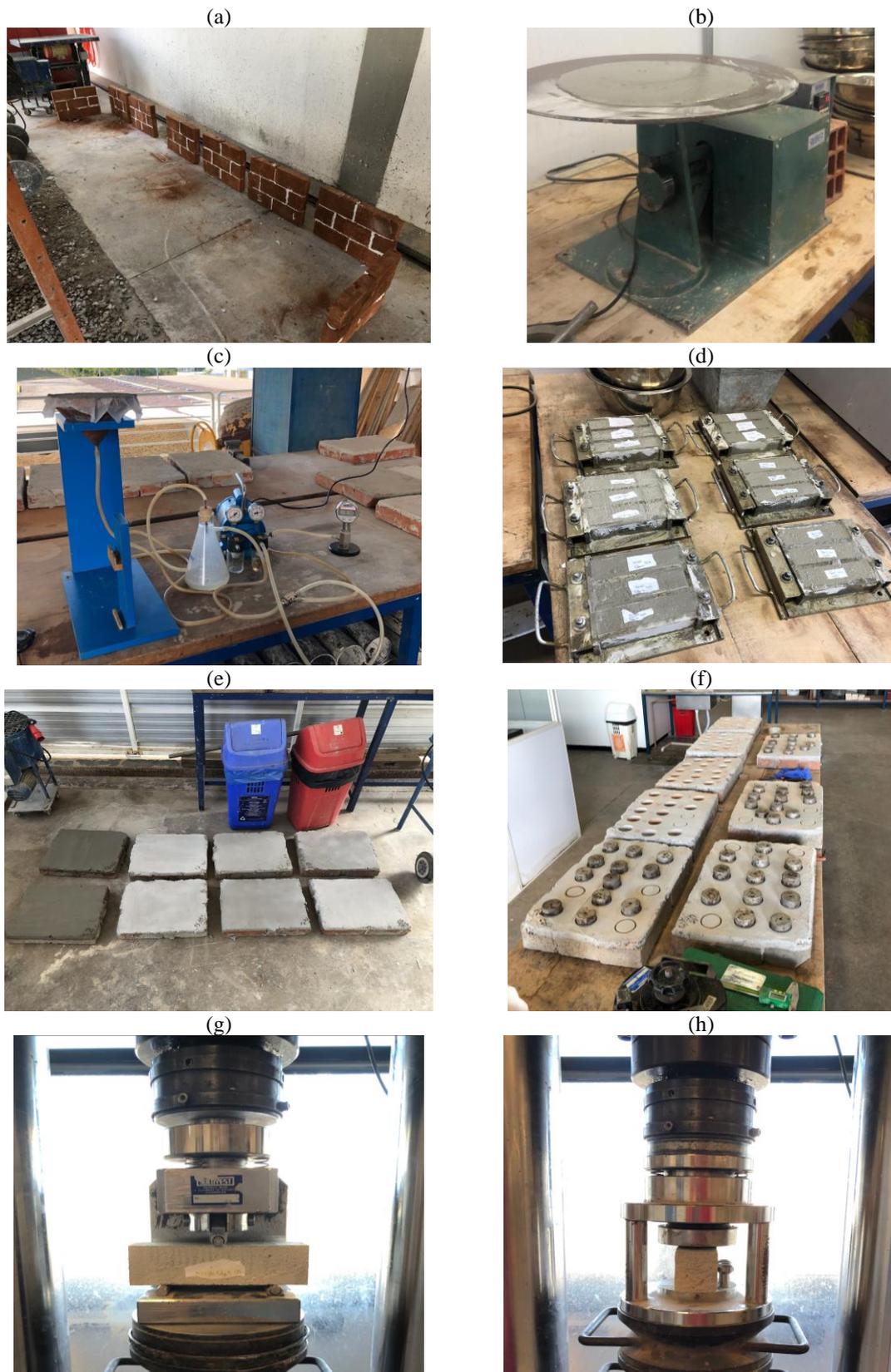
Figura 2 – Etapas do programa experimental: (a) Paredes moldadas sem chapisco; (b) determinação do índice de consistência da argamassa; (c) determinação da retenção de água; (d) corpos-de-prova prismáticos; (e) paredes revestidas; (f) ensaio de arrancamento; (g) determinação da resistência à tração na flexão; (h) determinação da resistência à compressão
