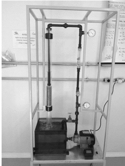
Figura 1 – Unidade experimental de permeabilidade
