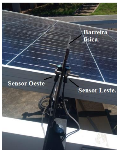
Figura 02 : Sensor instalado no seguidor solar. Fonte: Próprio autor.
