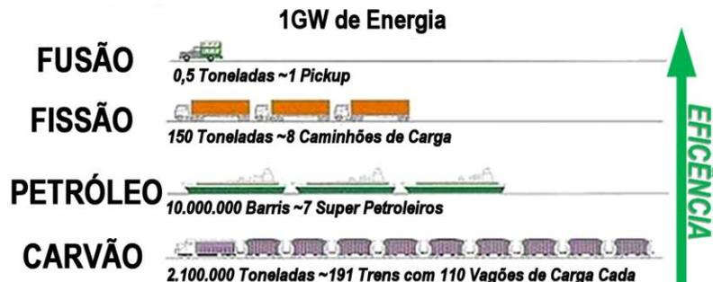
Figura 9 – Comparativo das eficiências dos combustíveis utilizados para gerar 1GW de eletricidade. Fonte: Adaptado de Wiltgen (2021).
