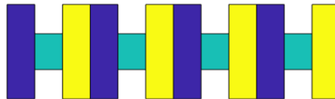
Figura 7: Modelo otimizado após 84 iterações/gerações. Áreas [6.9336, 1.0000, 6.9336]
