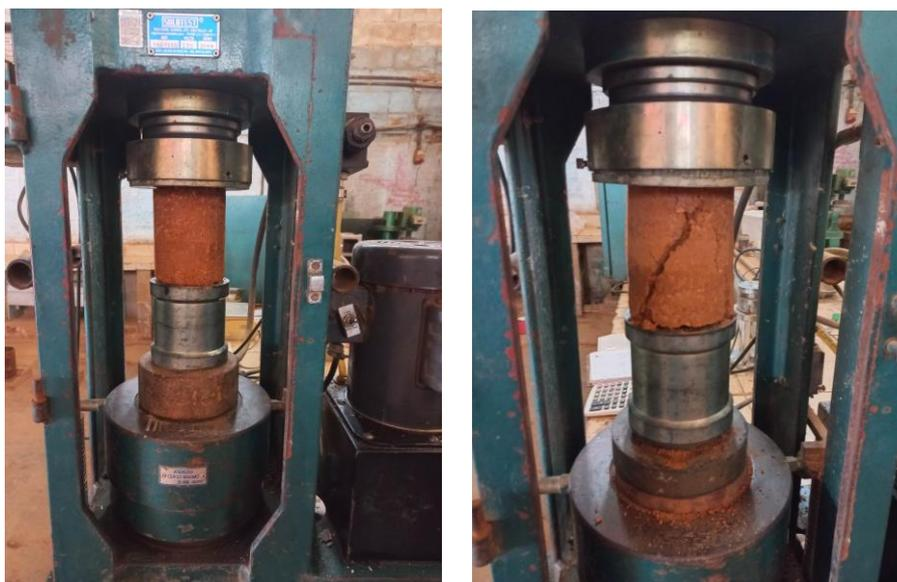
Figura 2 – Ensaio de RCNC: a) Preparação do corpo-de-prova; e b) Corpo-de-prova após o ensaio
