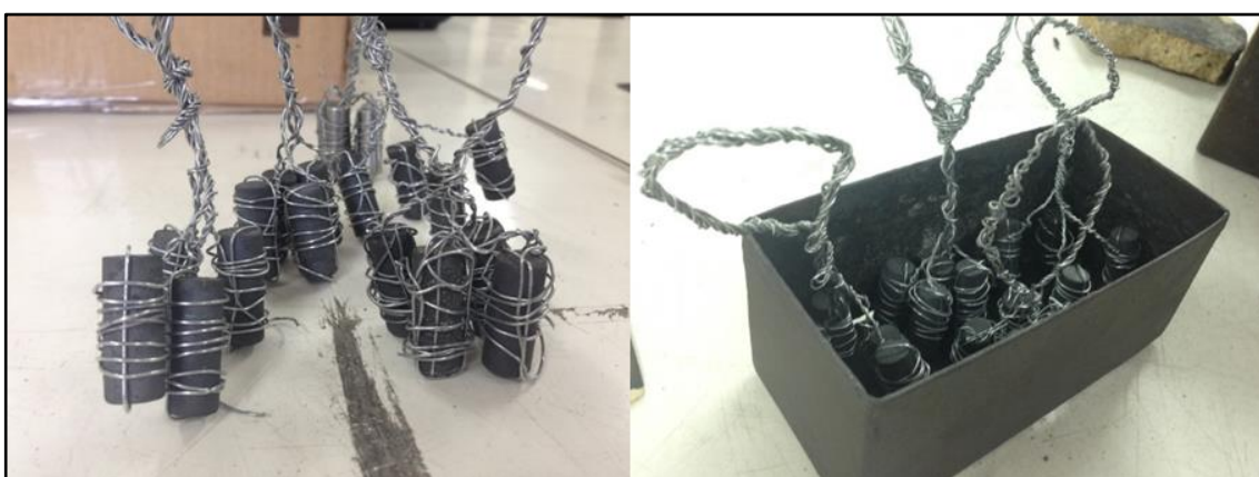
Figura 01 - (a) À esquerda, corpos de prova reunidos em grupos de quatro unidades; (b) À direita, recipiente utilizado para guarnição das amostras e granulado de baixo teor de carbono
