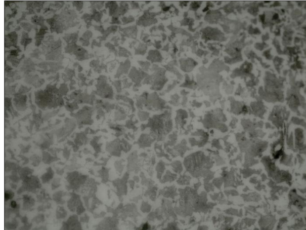
Figura 06 - Metalografia da amostra normalizada (400x)
