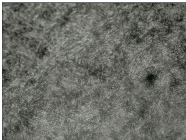
Figura 10 - Metalografia da amostra temperada em óleo e revenida (400x)
