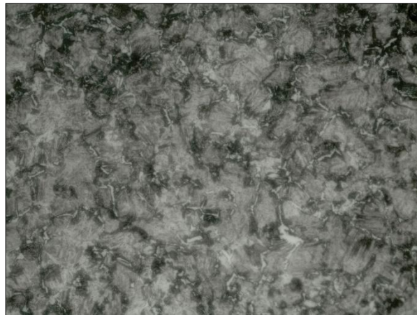
Figura 09 - Metalografia da amostra temperada em óleo (400x)
