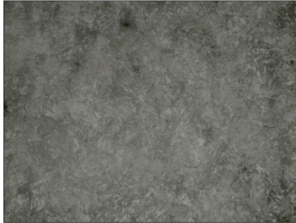
Figura 08 - Metalografia da amostra temperada em água (400x)
