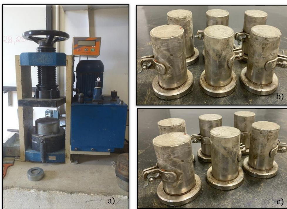
Figura 4 – Avaliação resistência mecânica: (A) máquina de teste universal, (B) e (C) corpo de prova moldados
