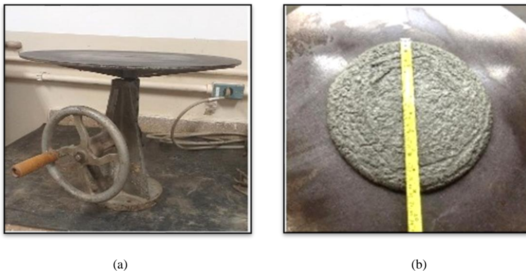
Figura 2 – Avaliação da fluidez: (a) mesa de fluxo, (b) espalhamento da massa
