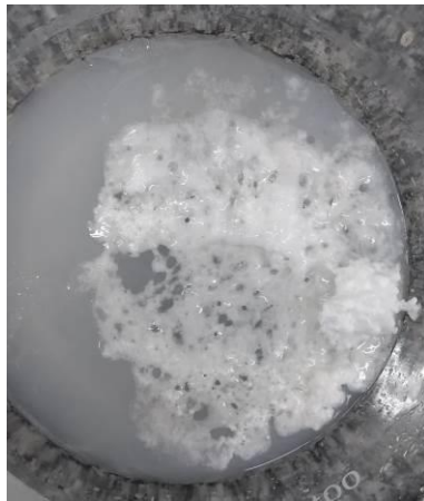
Figura 2 – Dissolução do poliestireno.
