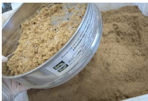
Figura 1 – Peneiramento do resíduo
