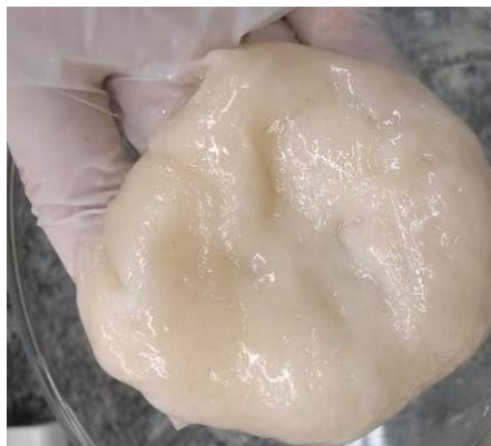
Figura 7 – Dissolução de EPS.
