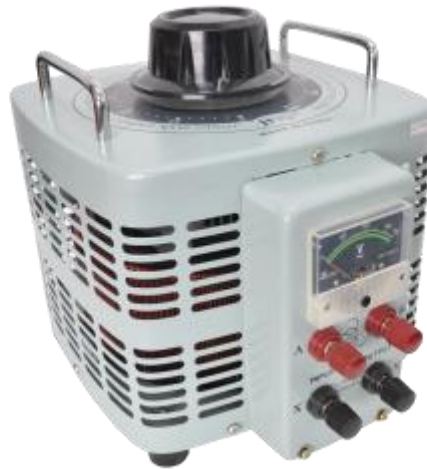
Figura 2: Representação do Variac utilizado no LABEMM
