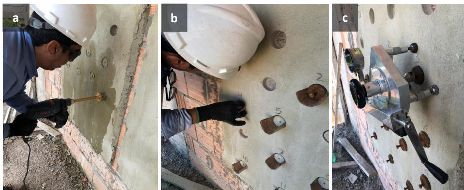
Figura 3 – Método executivo para a aferição da resistência de aderência à tração dos sistemas de revestimento de argamassa: a) execução do corte dos CPs; b) colagem das pastilhas metálicas de mesmo diâmetro dos CPs; c) ancoragem do dinamômetro de tração nas pastilhas metálicas e posterior aplicação da tensão de tração.
