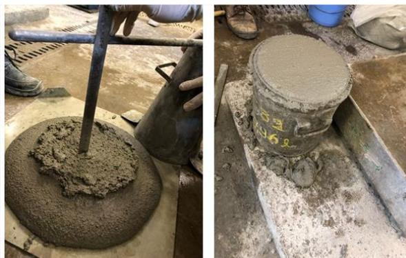
Figura 3 - Determinação do abatimento de tronco de cone e densidade – Fonte: Autor (2022)
