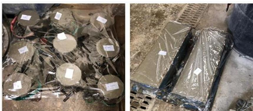
Figura 4 - Processo de cura inicial dos corpos de prova - Fonte: Autor (2022)
