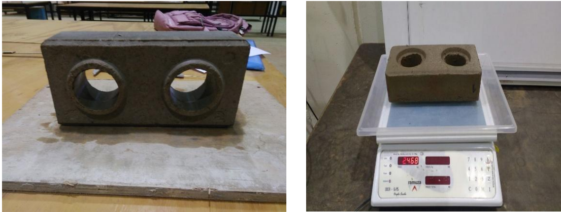
Figura 5- a) primeiro traço após a cura; b) Primeiro traço pesagem
