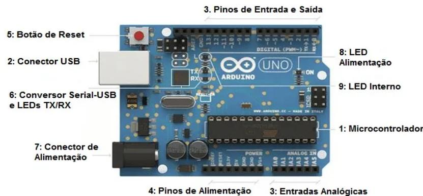
Figura 2 - Principais elementos da placa Arduino Uno
