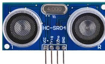
Figura 3 - Sensor Ultrassônico HC-SR04
