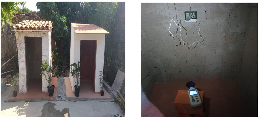
Figura 6 - Modelos Steel Frame e Alvenaria Convencional concluídos e decibelímetro em utilização.
