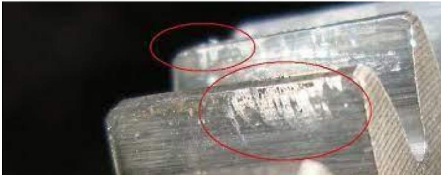
Figura 02 – Desgaste por abrasão (KAIO DUTRA, 2015)
