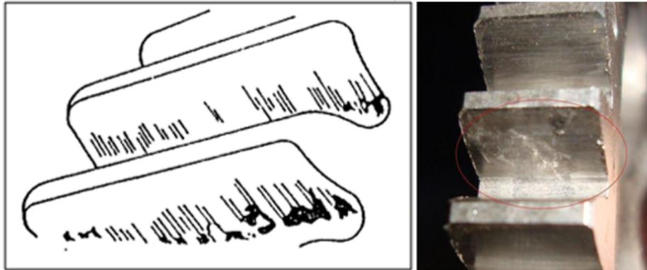
Figura 03 – Desgaste por interferência (KAIO DUTRA, 2015)
