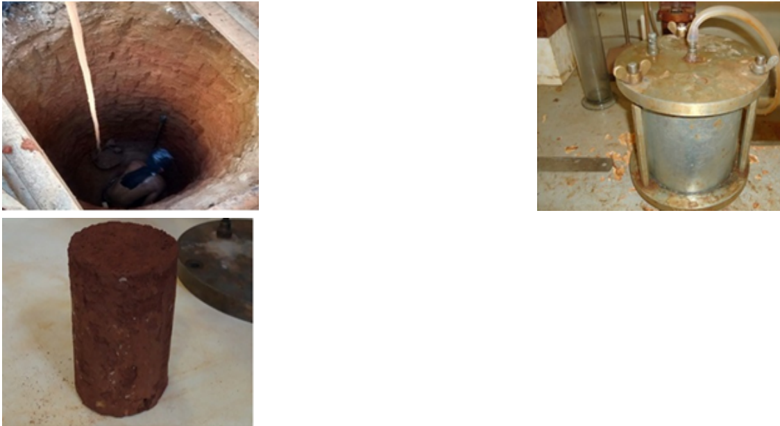
Figura 5 – (a) amostra retirada durante escavação tubulão, (b) detalhe do ensaio, (c) corpo de prova para ensaio. Fonte: autores (2023).
