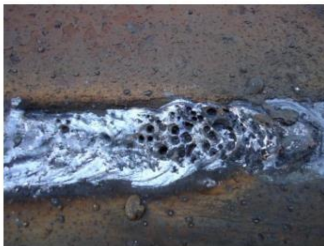
Figura SEQ Figura \* ARABIC 4 - Presença de porosidades na solda. Fonte: Próprio autor.
