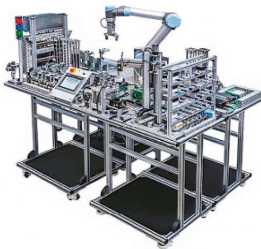
Figura 1 - Exemplo de modelo físico de um sistema de produção para o ensino teórico e prático de automação industrial.
