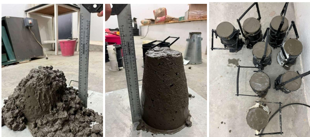
Figura 5 – (a) (b) Slump Test concreto sustentável (c) Corpos de prova moldados
