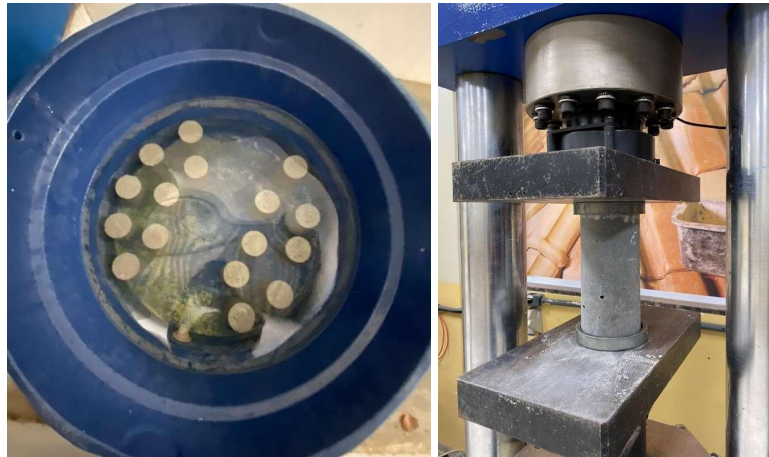
Figura 6 – (a) Corpos de prova no tanque para cura (b) Ensaio de compressão axial
