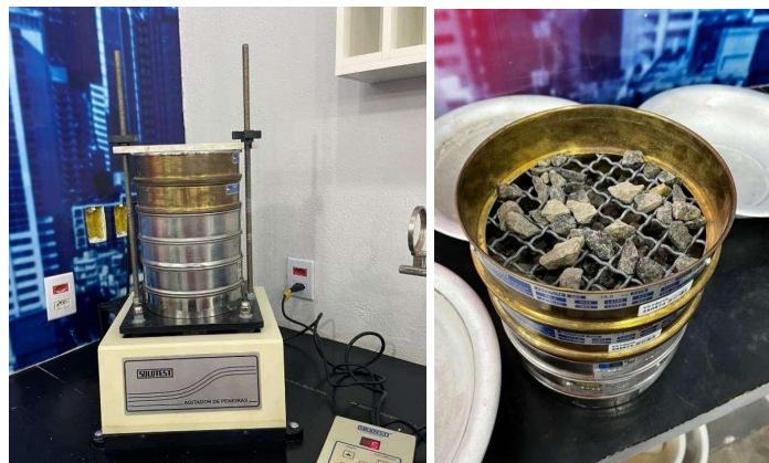
Figura 3 – (a) Agitador mecânico (b) Ensaio granulométrico da brita
