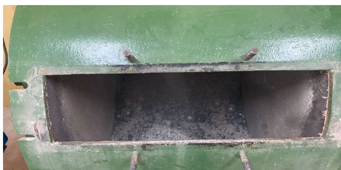
Figura 1 - Material no equipamento Abrasão de Los Angeles
