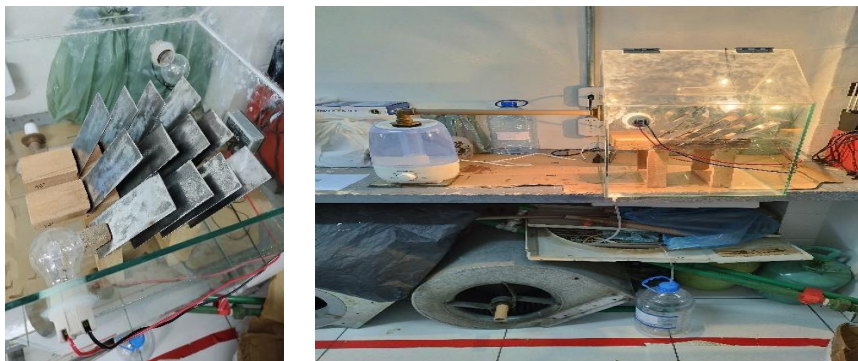
Figura 3 – Disposição dos cp's no equipamento
