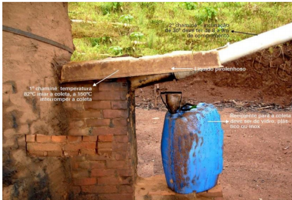
Figura 5 – Adaptação de um forno para geração de líquido pirolenhoso
