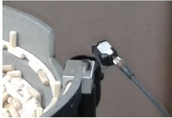
Figura 6 – Posição do sensor fotoelétrico por difusão no dispositivo.
