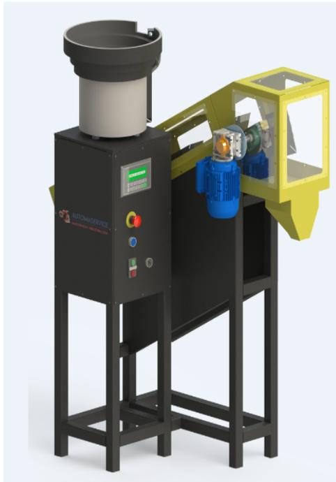
Figura 8 – Dispositivo de contagem de cavilhas.
