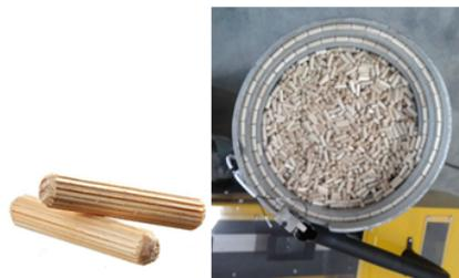
Figura 9 – Cavilha, material madeira tipo pinus.
