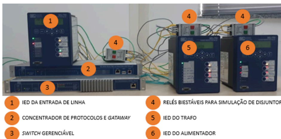
Figura 5 - Montagem Simplificada dos IEDs com arquitetura mínima para o experimento.
