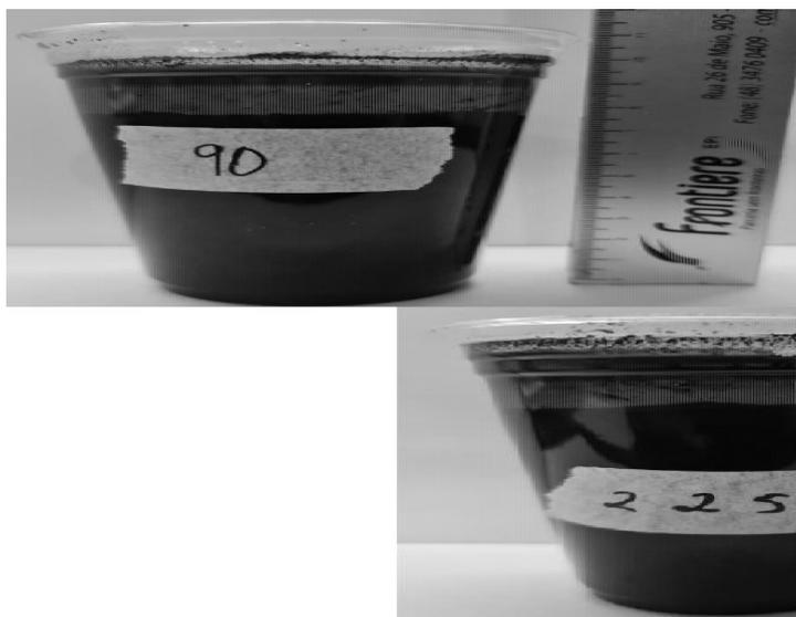
Devido ao baixo pH do sulfato de alumínio, o pH da solução nessa etapa encontrava-se em 3,5. Antes da adição dos floculantes, o pH foi corrigido para 7,3 com a adição de 35g de solução 0,1N de hidróxido de sódio.
