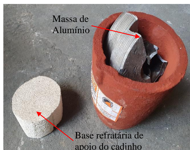
Figura 10 – Cadinho de SiC com massa de alumínio (fonte: Autores, 2024).
