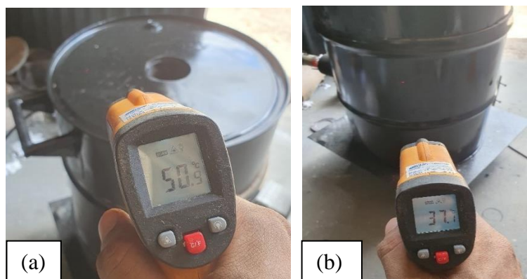
Figura 12 - medições de temperatura externa (a) tampa, (b) lateral do forno (fonte: Autores, 2024).
