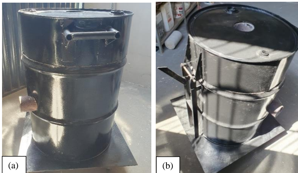
Figura 8 – Forno de fundição finalizado, (a) vista frontal, (b) vista posterior (fonte: Autores, 2024).
