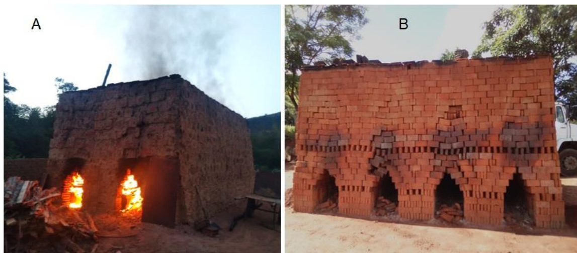
Figura 04 – (A) Caieira em processo de queima; (B) Após processo de queima.
