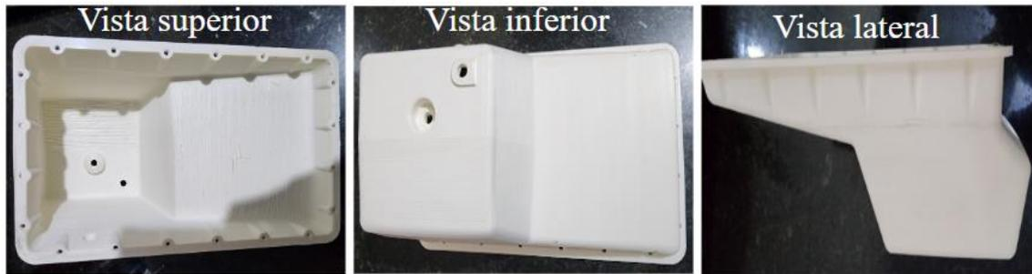
Figura 7. Fotografias da vista superior, inferior e lateral do protótipo do cárter obtido por impressão 3D.
