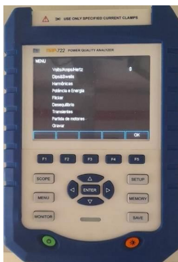
Figura 2 – Analisador de energia trifásico MAR-722.
