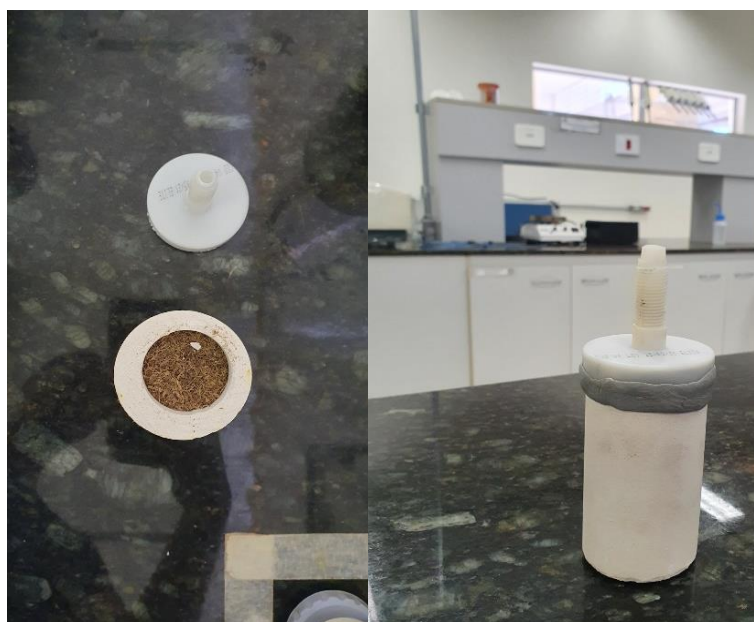
Figura 3 – Montagem dos filtros
