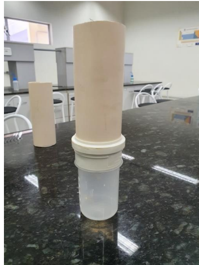
Figura 4 – Sistema de filtração montado em fluxo contínuo
